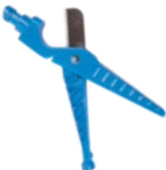
Uniwersalne narzędzie do emiterów P/N HEMT (Służy do wiercenia otworów, wykonywania i wyjmowania emiterów, oraz do przycinania przewodów)
