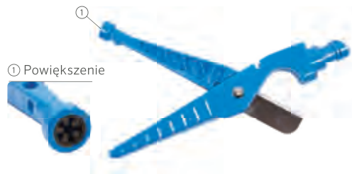
Uniwersalne narzędzie Hunter Emitter P/N HEMT (Służy do wiercenia otworów, wstawiania i wyjmowania emiterów, przycinania przewodów)
