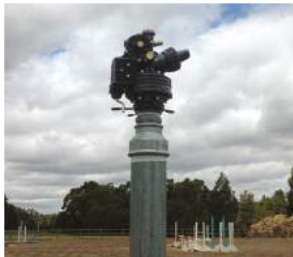
Zainstalowany rotor ST-1600-HS-BR
