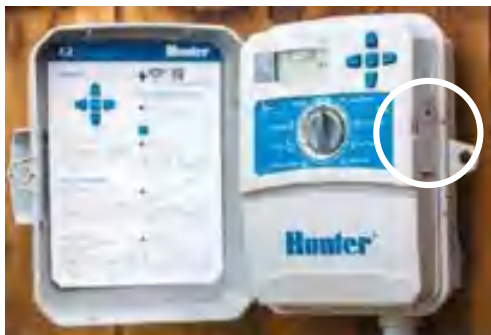
Sterownik X2 z zainstalowanym modułem WAND
