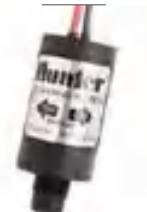
Cewka blokująca na prąd stały (nr części 458200) Jeden czarny przewód (wspólny) i jeden przewód czerwony (sekcja)
